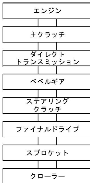
ダイレクトドライブ方式の動力伝達
